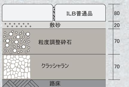
注：保水性ブロックの透水係数が $1.0 \times 10^{-2} \text{ cm/sec}$ 以上を有する場合は、透水性舗装の構造に準拠することになります。
