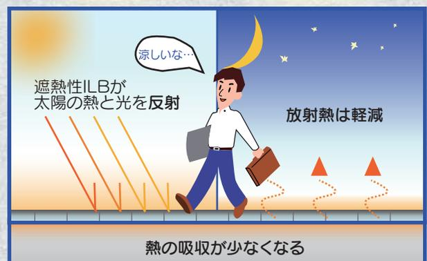
■舗装を暖める太陽光を反射し、表面温度を低減します。
