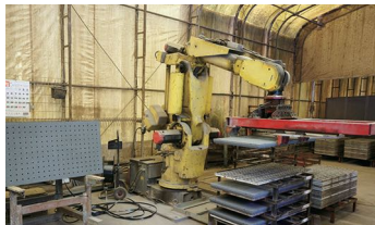
残存型枠用脱型ロボット
