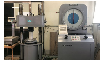
コンクリート強度試験場
