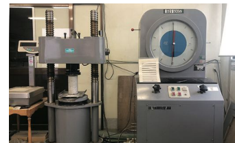
コンクリート強度試験場
