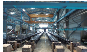
Hパイル製造ライン
