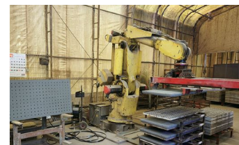
残存型枠用脱型ロボット
