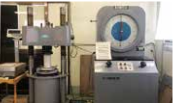
コンクリート強度試験場
